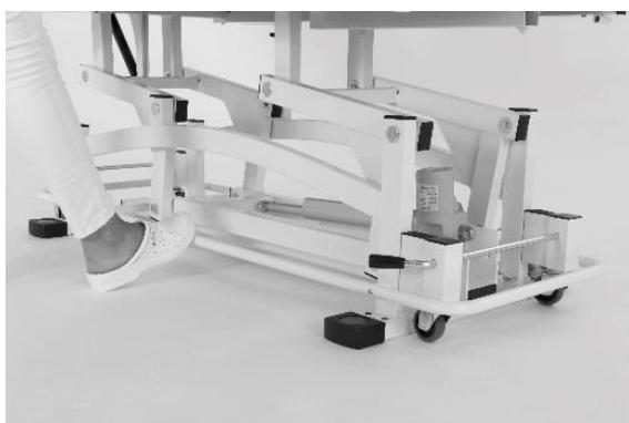
La hauteur de la table de 45 à 90 cm est réglée simplement appuyant sur ou soulevant le cadre de commande qui suit le périmètre du châssis de la table.
