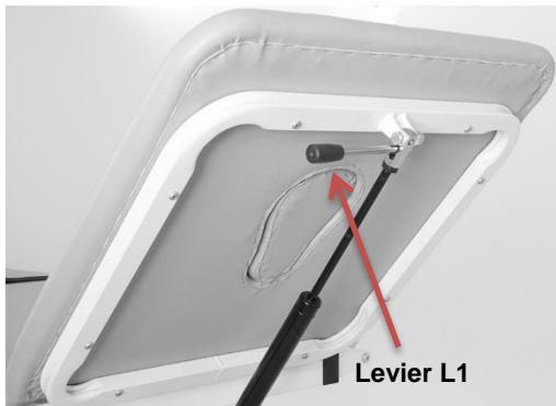
La tête peut être réglée avec vérin à gaz, activé avec un levier. Pour régler le proclive tirez le levier L1, réglez la position et relâchez le levier L1 pour fixer la position.
