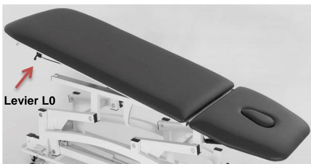
La table ELIA peut être réglée en position de Trendelenburg. Le plateau peut être réglé avec un vérin à gaz, activé avec un levier. Pour régler le proclive tirez le levier L0, réglez la position et relâchez le levier L0 pour fixer la position.
