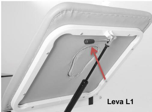
La testata è regolabile mediante molla a gas con sblocco controllato tramite apposito comando. Per regolare l'inclinazione della sezione premere il comando (L1) e regolare nella posizione desiderata; rilasciare la leva L1
