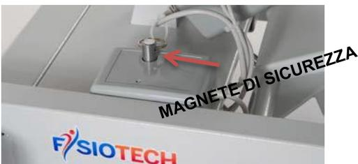
Oltre al MAGNETE DI SICUREZZA (sopra descritto) è inserito un software grazie al quale la regolazione del lettino viene attivata solo tramite **doppio impulso del comando (DOPPIO CLIC)**. Questo sistema è stato studiato per evitare azionamenti involontari anche da parte dell'operatore.
